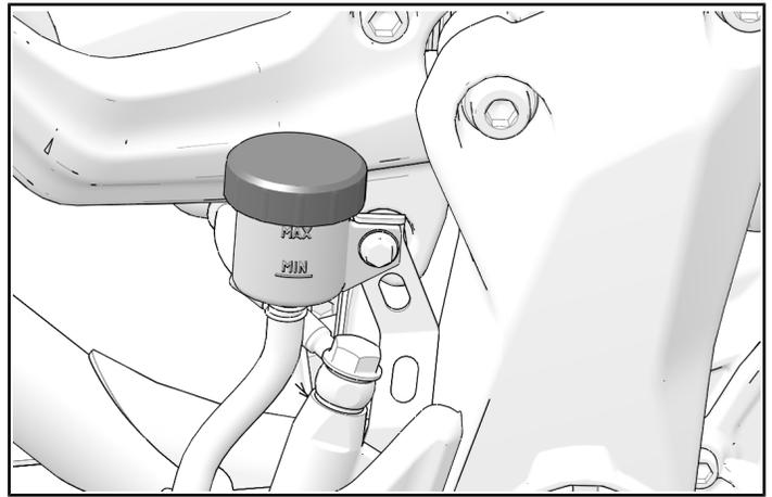
2. Apriete a mano la cubierta accesoria del depósito. Asegúrese de que el sello que se guardó esté entre la cubierta y el depósito.
