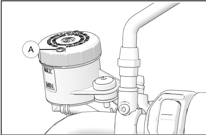
2. Coloque la cubierta del depósito accesoria (1) con los dos fijadores de la cubierta que se guardaron (A). Asegúrese de que el sello que se guardó esté entre la cubierta y el depósito. Apriete a mano los fijadores de la cubierta.
