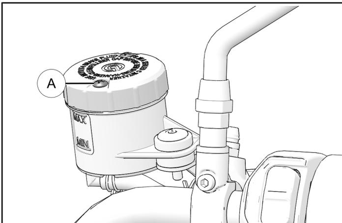
2. Installer le couvercle de réservoir accessoire (1) avec les deux fixations de couvercles (A) conservées. S'assurer que le joint conservé se trouve entre le couvercle et le réservoir. Serrer les fixations de couvercle à la main.
