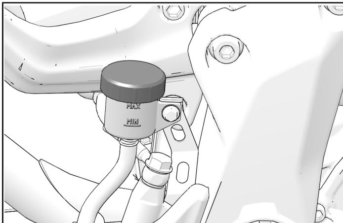
2. Serrer à la main le couvercle de réservoir accessoire. S'assurer que le joint se trouve entre le couvercle et le réservoir.
