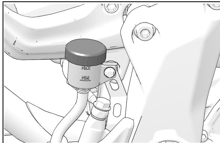
2. Stringere a mano la copertura del serbatoio accessorio. Verificare che la guarnizione messa da parte precedentemente sia presente tra la copertura e il serbatoio.
