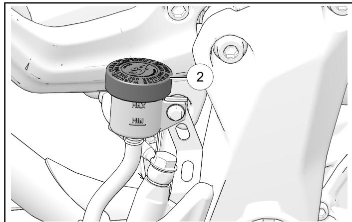
2. Installare la copertura del serbatoio accessorio ① con due relativi dispositivi di fissaggio ② messi da parte precedentemente. Verificare che la guarnizione sia presente tra la copertura e il serbatoio. Stringere a mano i dispositivi di fissaggio della copertura.
