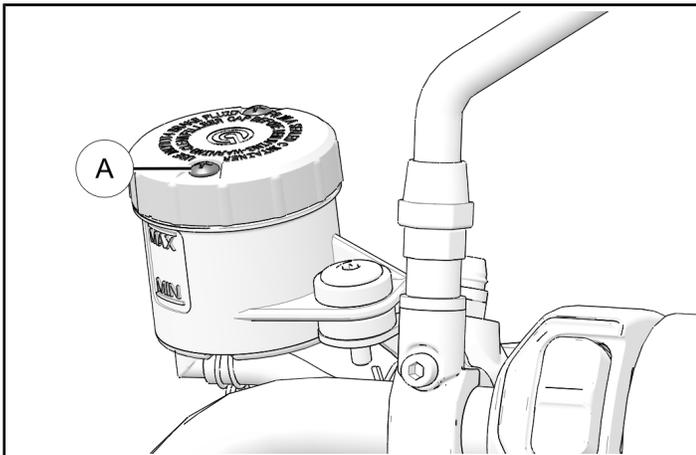
2. 用之前保留的两枚储液罐盖紧固件①安装附属储液罐盖①。确保之前保留的密封件位于罐盖和储液罐之间。徒手拧紧罐盖紧固件。
