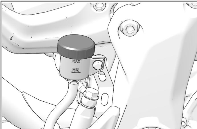
2. 徒手拧紧附属储液罐盖。确保之前保留的密封件位于罐盖和储液罐之间。
