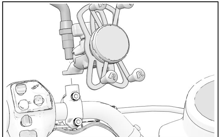
2. Serrer le contre-écrou du rétroviseur (A).
