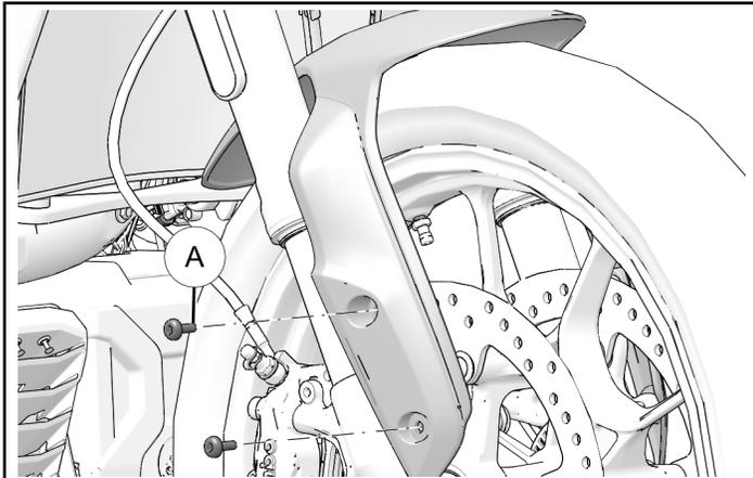
2. Rechten Gabelschutz ① zum vorderen Schutzblech ausrichten. Vor dem Befestigen des Unterteils das obere Befestigungsteil ④ und den Druckbegrenzer ⑥ lose einbauen. Unterteil mit dem unteren Befestigungsteil ③ und dem Druckbegrenzer ⑤ lose montieren.
