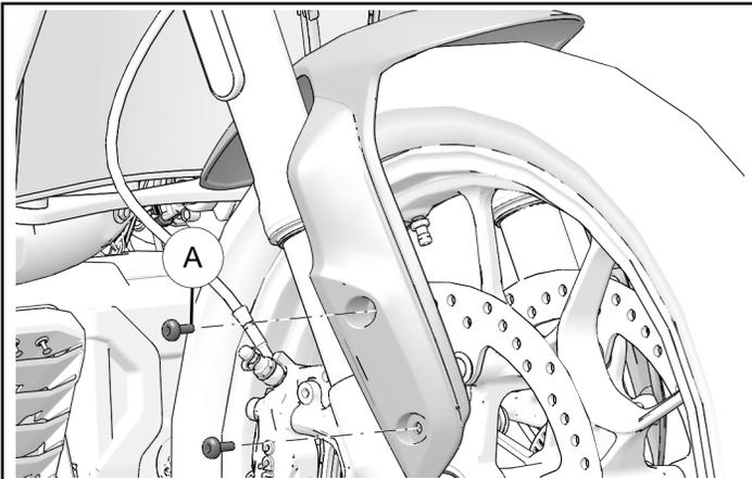
2. Allineare la protezione della forcella lato destro ① con il parafango anteriore. Installare, senza serrare, il dispositivo di fissaggio superiore ④ e il limitatore di compressione ⑥ prima di fissare quello inferiore. Installare, senza serrare, il dispositivo di fissaggio inferiore ③ e il limitatore di compressione ⑤.
