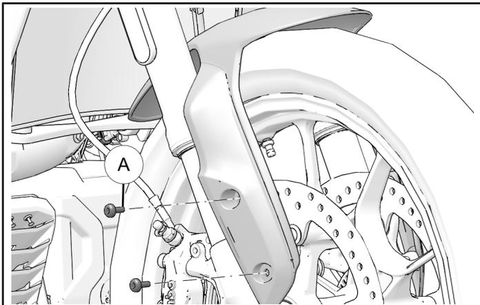
2. 将右侧车叉护罩①对准前挡泥板。固定底部之前，先安装顶部紧固件④和压缩限制器⑥，暂时不要拧紧。使用底部紧固件③和压缩限制器⑤安装底部，暂时不要拧紧。
