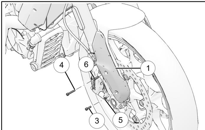
3. 从挡泥板上拆下两枚螺钉Ⓐ并丢弃。
