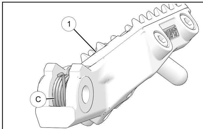
2. Fußraste (1) in die Fußrastenbefestigung einsetzen und vorher aufgehobenen Bolzen (B) durch die Halterung und die Fußraste (1) führen. Sicherstellen, dass das Federende (C) in den Fußrastenaufnehmer eingepasst ist.
