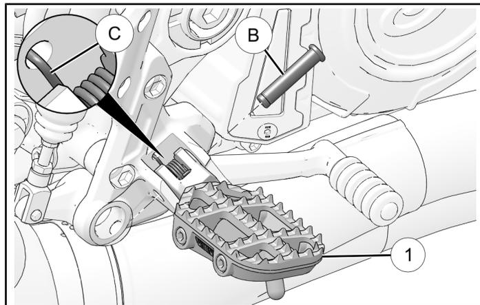
3. Den Bolzen (B) mit dem Sicherungsring (4) befestigen.
