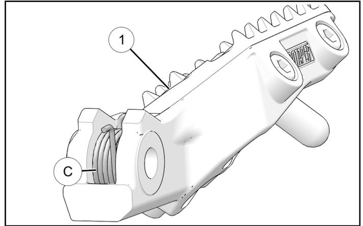
2. Coloque el reposapiés (1) dentro del soporte del reposapiés e introduzca el pasador que se guardó (B) a través del soporte y el reposapiés (1). Asegúrese de que el extremo del muelle (C) esté ajustado en el hueco del soporte del reposapiés.
