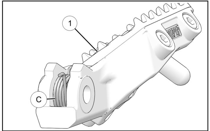
2. Inserire il poggiaiedi **1** nel suo supporto e infilare il perno messo da parte precedentemente **B** nel supporto e nel poggiaiedi **1**. Accertarsi che l'estremità della molla **C** si trovi nella cavità del supporto del poggiaiedi.
