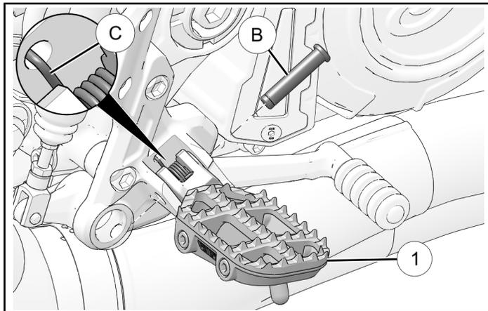
2. 拆下并保留一个销⑧和一个脚蹬弹簧③以拆下脚蹬。
