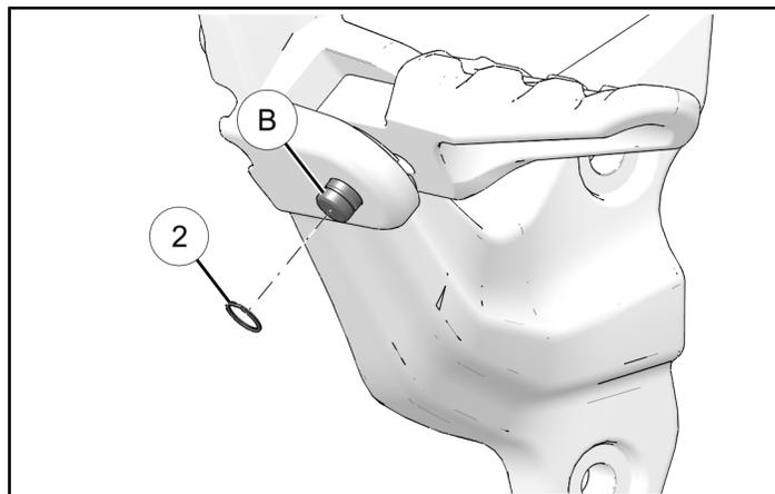
4. Neue Soziusfußraste mit Original-Befestigungslöchern ausrichten. Die zwei aufbewahrten Fußrasten-Befestigungsteile (G) anbringen.
