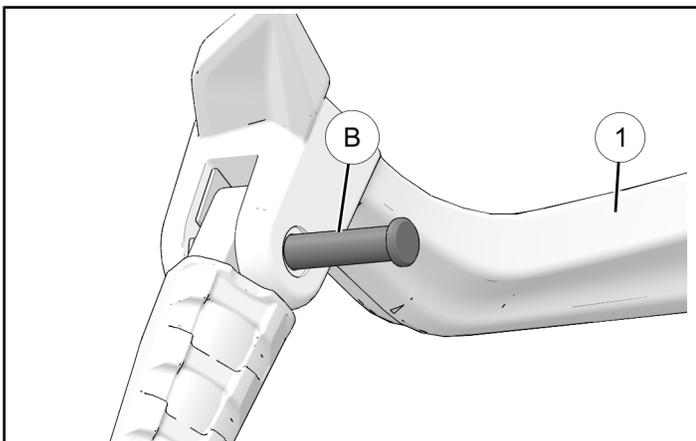
3. Sicherungsring (2) in Nut von Bolzen (B) platzieren, um Fußrastenbaugruppe zu fixieren.
