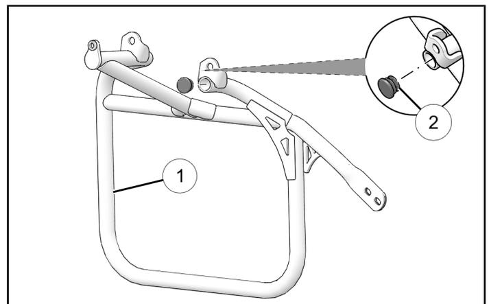
3. Alinee el soporte de la bolsa lateral ① con el soporte accesorio, tal como se muestra. Sin apretar, instale los dos fijadores superiores de montaje ③, las dos arandelas de seguridad ⑧ y las dos tuercas ⑥.
