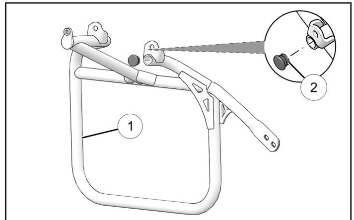
3. Aligner le support de sac latéral ① avec le support de montage d'accessoires, tel qu'illustré. Installer sans serrer avec deux fixations de montage supérieures ③, deux rondelles-frein ⑧ et deux écrous ⑥.
