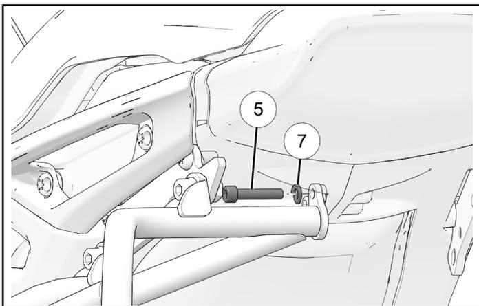
5. Installer sans serrer le support de sac latéral à l'arrière du repose-pieds de passager à l'aide de deux fixations de repose-pieds ④.
