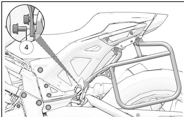
6. Serrare tutti i dispositivi di fissaggio alle coppie specificate.
