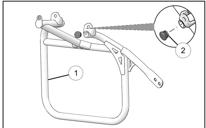
3. Allineare l'attacco della borsa laterale ① con l'attacco per accessori, come indicato. Installare, senza serrare, due dispositivi di fissaggio di montaggio superiori ③, due rondelle di sicurezza ⑧ e due dadi ⑥.
