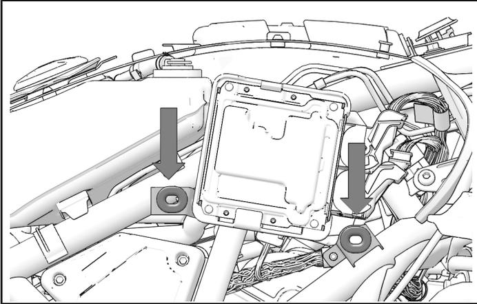
3. Placer chaque protection de réservoir sur le support d'alignement. Vérifier que chaque languette d'alignement est insérée dans le trou correspondant de la protection de réservoir.
