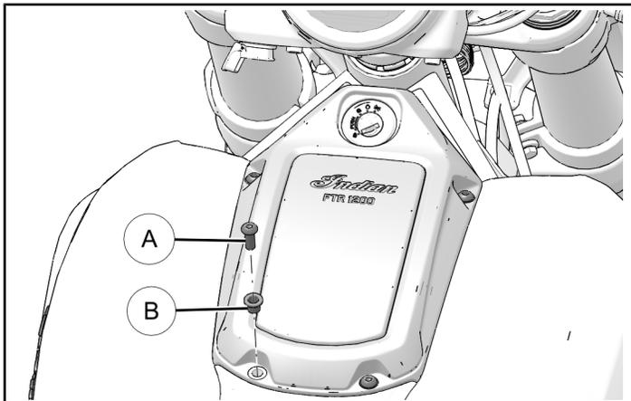
2. Incliner la console centrale vers le haut pour la retirer de la protection de réservoir.
