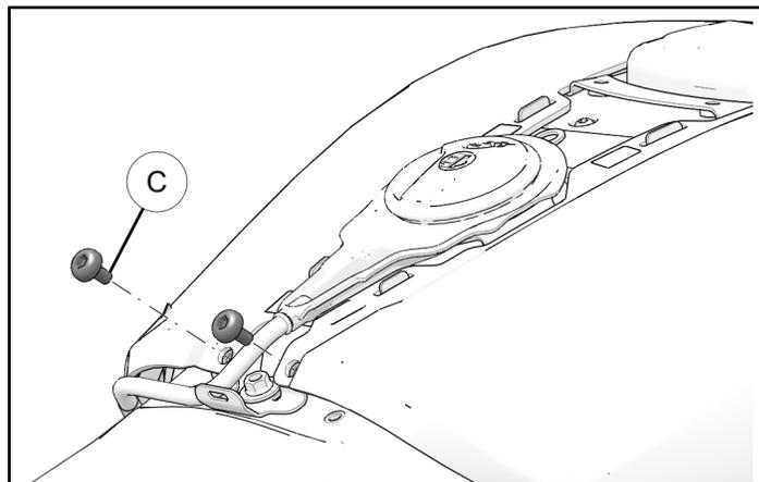
4. Tirer la partie inférieure de chaque protection de réservoir vers l'extérieur pour dégager les rivets en plastique aux deux emplacements indiqués.
