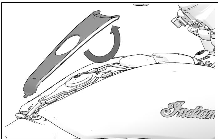
3. Retirer et conserver les deux fixations (C) des protections de réservoir à l'arrière des protections de réservoir.
