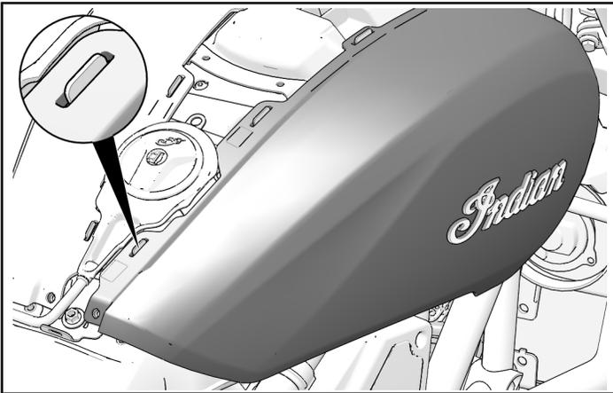
4. Pousser fermement la protection de réservoir inférieure dans les œillets. Vérifier que les deux rivets de la protection de réservoir sont bien en place et que l'œillet n'a pas traversé le support.
