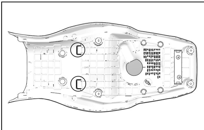
2. 本节步骤1中标示的卡扣将滑动到座椅支架下方。
