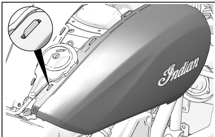
4. 将油箱盖板下部用力推入套环。确保两枚油箱盖板铆钉牢固固定住且套环没有穿过支架。
