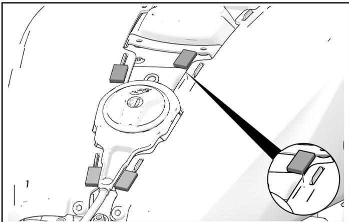
7. 将中控台蝶片置于底部支架内，向下翻转进入安装位置。用力按压垫粘贴位置，确保每个垫均粘贴至油箱盖板上。
