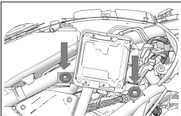
3. 将每个油箱盖板置于对准支架上。确保每个对准蝶片完全进入对应的油箱盖板孔。
