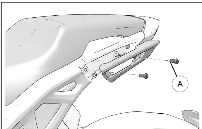
2. 从摩托车车架两侧，各拆下一枚扶手紧固件②并保留。
