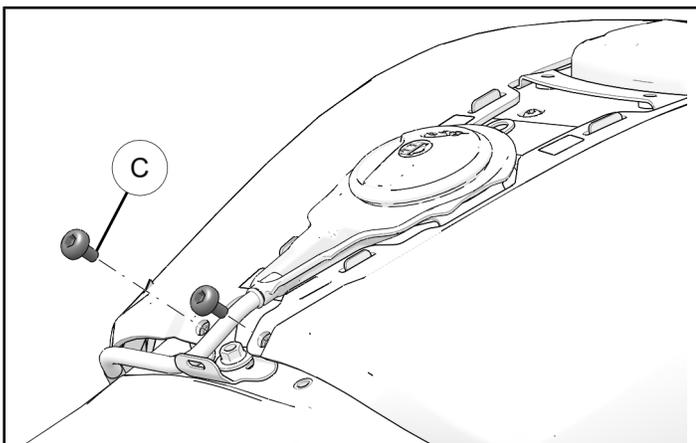
4. 向外拉动每个油箱盖板底部以便使两个标记位置处的塑料铆钉分开。
