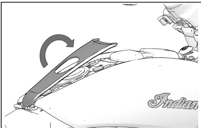
8. 使用之前保留的四个边框紧固件①和之前保留的四个压缩限制器②重新安装油箱边框。
