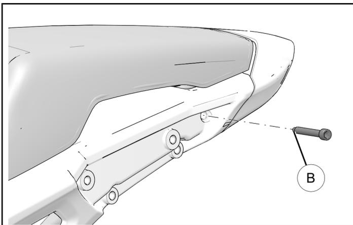
3. 向后上方滑动座椅，确保座椅从底座中滑出，从而将其从摩托车上拆下。
