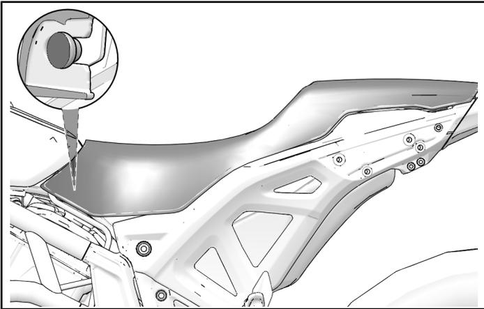
4. 使用之前保留的两枚座椅紧固件⑧固定住座椅后部。
