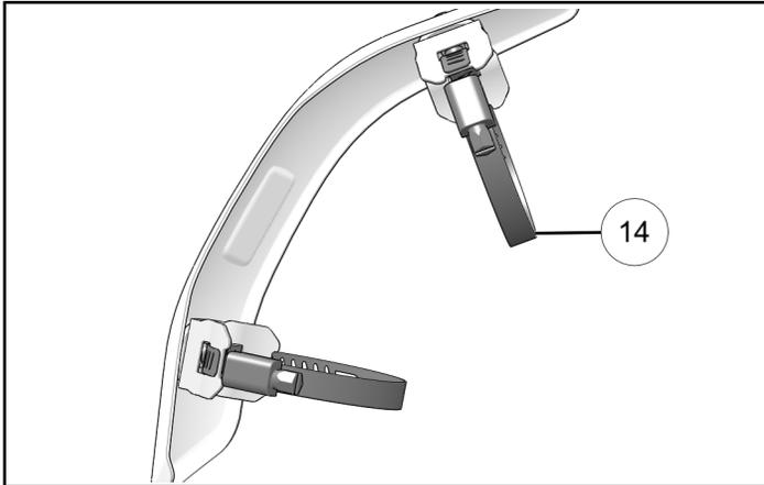
6. Oberen Hitzeschild über dem oberen Auspuffrohr anbringen. Sicherstellen, dass der Hitzeschild die Verbindung zwischen dem oberen Schalldämpfer und dem Auspuffrohr überlappt. Klemmen festziehen, um Hitzeschild zu fixieren.
