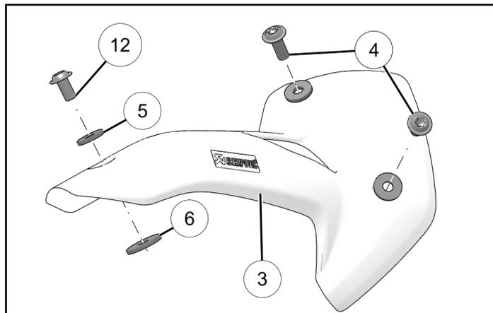
8. Unteren Hitzeschild ③ an Auspuffrohrhalterungen montieren. Sicherstellen, dass Distanzscheiben mit den Haltebügel-Muttern unter dem Hitzeschild ausgerichtet sind.
