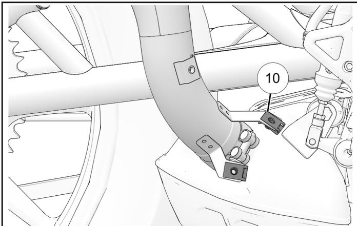
6. Sicherstellen, dass die beiden Hitzeschild-Befestigungsteile ④ (lang) an den unteren Befestigungspunkten verwendet werden. Wenn die Befestigungsteile ④ (lang) statt Befestigungsteil ⑫ (kurz) am oberen Befestigungspunkt verwendet werden, kann dies dazu führen, dass das Befestigungsteil ins Auspuffrohr eindringt und dies beschädigt.
