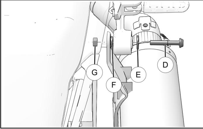
4. Auspuffanlage von Resonator entfernen und auf weicher Unterlage ablegen, bevor fortgefahren wird.
