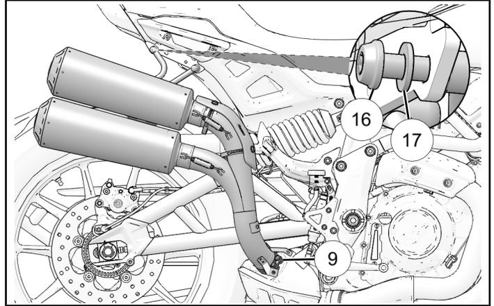
2. Klemme ⑨ an Basis des Auspuffrohrs festziehen.
