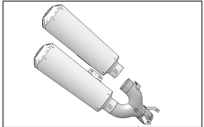
4. Antes de seguir, desmonte el sistema de escape del resonador y coloque el sistema de escape sobre una superficie suave.
