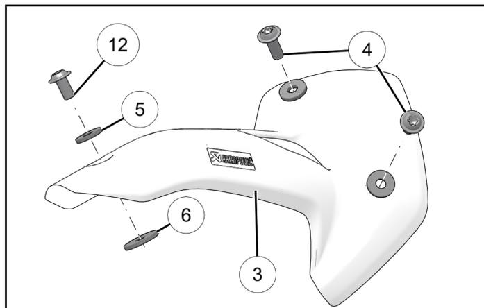
8. Coloque el protector inferior contra el calor ③ sobre los soportes del tubo de escape. Asegúrese de que los espaciadores estén alineados con las tuercas presilla debajo del protector contra el calor.
