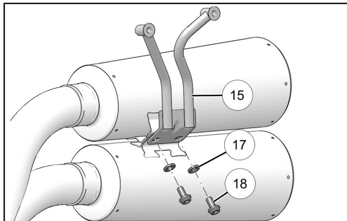
4. Monter deux goussets ⑮ sur l'écran thermique supérieur ⑪ avec deux fixations d'écran thermique ⑫, deux rondelles ⑤ et deux entretoises ⑥, tel qu'illustré. S'assurer que les entretoises ⑥ sont installées entre le gousset ⑮ et le dessous de l'écran thermique ⑪.
