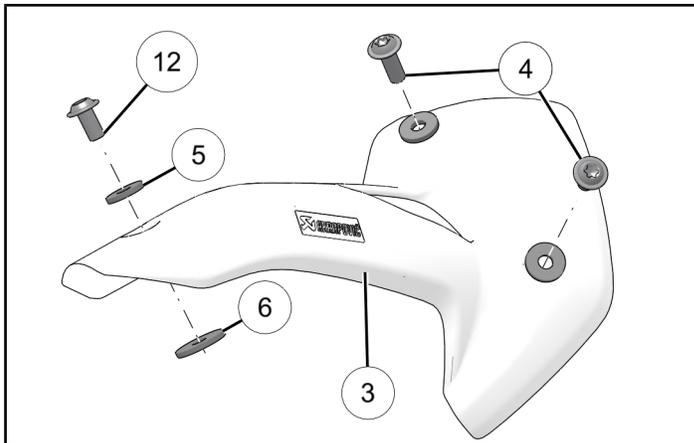
8. Monter l'écran thermique inférieur ③ sur les supports de tuyaux d'échappement. S'assurer que les entretoises sont alignées avec les écrous à clip sous l'écran thermique.
