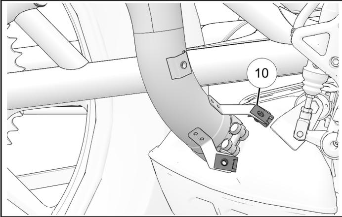
6. Verificare che nei punti di fissaggio inferiori vengano usati due dispositivi di fissaggio per scudi termici <sup>4</sup> (lunghi). L'utilizzo di dispositivi di fissaggio <sup>4</sup> (lunghi) invece di <sup>12</sup> (corti) per gli attacchi superiori potrebbe causarne l'installazione nel tubo di scarico, danneggiandolo.
