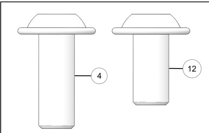
7. Infilare i dispositivi di fissaggio <sup>4</sup> e <sup>12</sup> dello scudo termico nelle rondelle <sup>5</sup>, nello scudo termico <sup>3</sup> e nei distanziali <sup>6</sup>.
