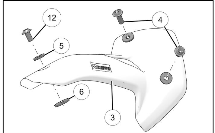
8. Installare lo scudo termico inferiore <sup>3</sup> sugli attacchi del tubo di scarico. Verificare che i distanziali siano allineati ai dadi a fermaglio al di sotto dello scudo termico.
