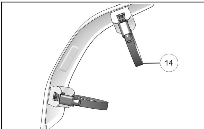
6. Collocare lo scudo termico superiore al di sopra del tubo di scarico superiore. Verificare che lo scudo termico si sovrapponga al collegamento tra il silenziatore superiore e il tubo di scarico. Stringere le fascette per fissare lo scudo termico.
