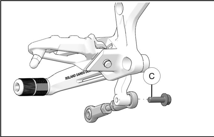
8. 用紧固件④将换档联杆重新安装到换档杆上。
