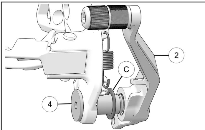
6. 用垫圈①和卡环②固定住制动踏板。
