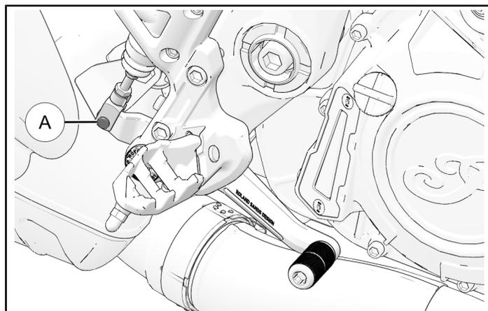
9. 将脚蹬和制动主缸对齐，用两枚制动主缸安装紧固件①和两枚脚蹬紧固件②重新安装脚蹬。
