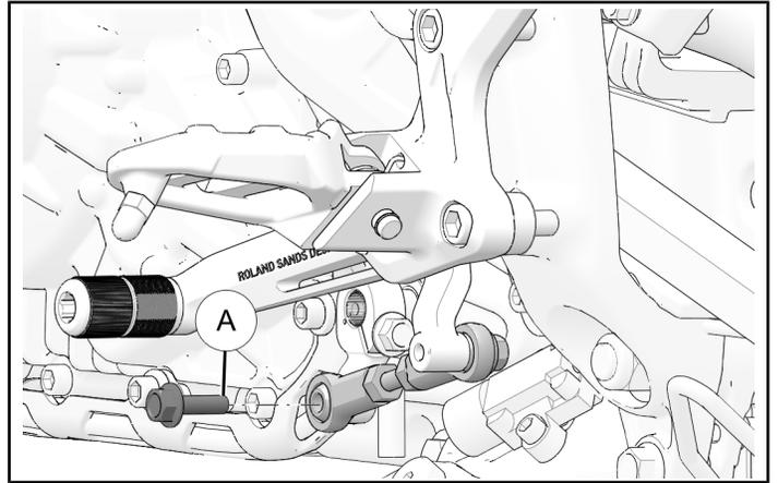
7. 使用之前保留的两枚脚蹬紧固件⑤重新安装脚蹬支架。
