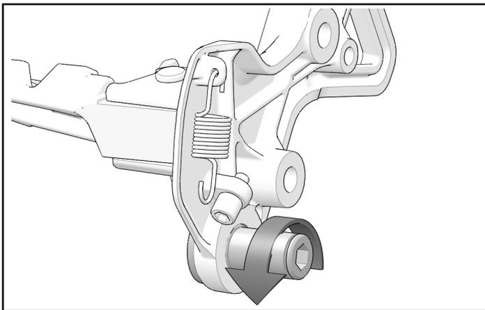
5. 将波形垫圈③和换挡踏板②安装到有肩螺钉上。如图中所示方向，将弹簧挂到制动踏板上。
