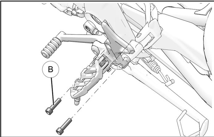
3. 拆下后换档联杆螺栓③并保留。
