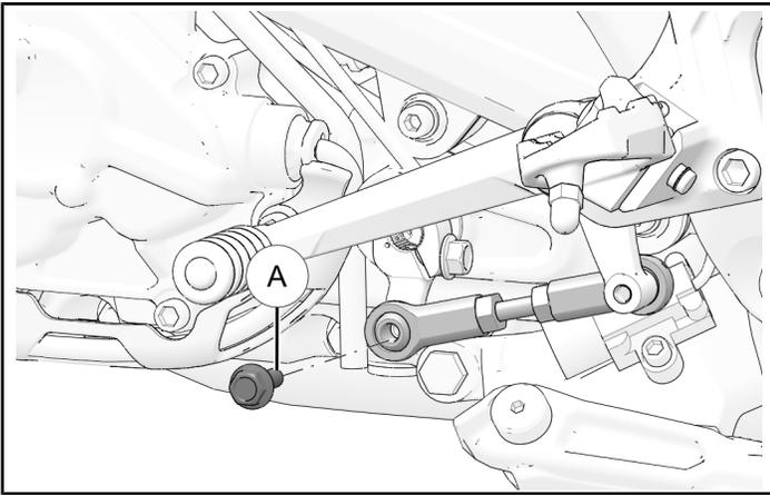
2. 拆下两枚脚踏支架螺栓②并且将支架从摩托车上拆下。
