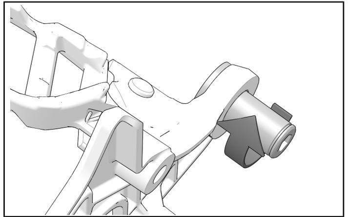
4. 将波形垫圈⑩、换档踏板③和垫圈⑪安装到有肩螺钉上。用卡环⑨固定。
