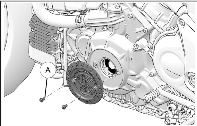
2. RSD®-Motordeckel ① mit zwei Schrauben ② montieren.
