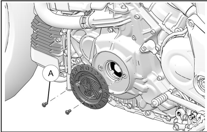
2. Coloque la cubierta del motor RSD® (1) con dos tornillos (2).
