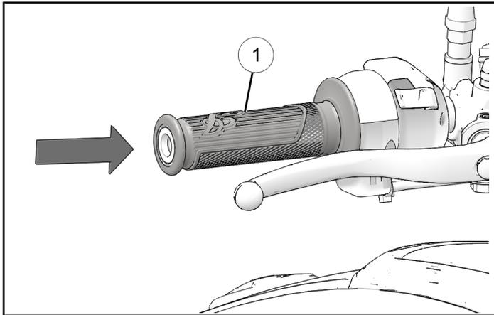
3. 将车把端紧固件④部分旋入楔形锚固组件内。将楔形锚固件滑入车把管，直到车把端与车把管齐平。
