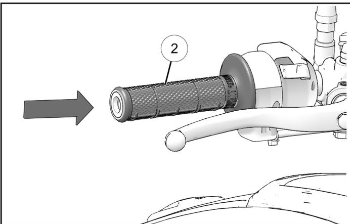
3. Lenkerende-Befestigungsteil ① nicht ganz in die Keilankerbaugruppe drehen. Keilanker in das Lenkerrohr schieben, bis das Lenkerende mit dem Lenkerrohr bündig ist.
