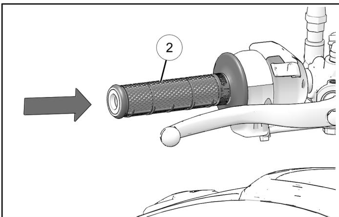
3. Visser partiellement la fixation d'embout de guidon ① dans l'assemblage d'ancrage à coin. Glisser l'ancrage à coin dans le tube du guidon jusqu'à ce que l'embout de guidon soit au ras du tube du guidon.
