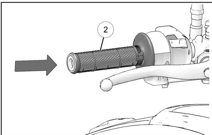
3. Avvitare parzialmente il dispositivo di fissaggio dell'estremità del manubrio ① nel gruppo di ancoraggio a cuneo. Far scorrere l'ancoraggio a cuneo nel tubo del manubrio finché l'estremità non è a filo del manubrio.
