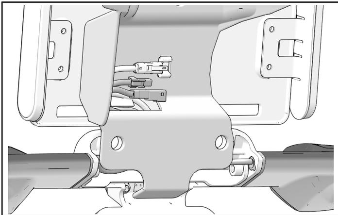
3. Vuelva a instalar el conjunto de la matrícula en el brazo de la matrícula con tres tornillos ④.
