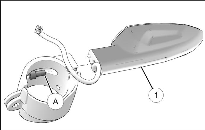
2. Asegúrese de que el arnés del intermitente ① quede dentro del canal del soporte del intermitente.
