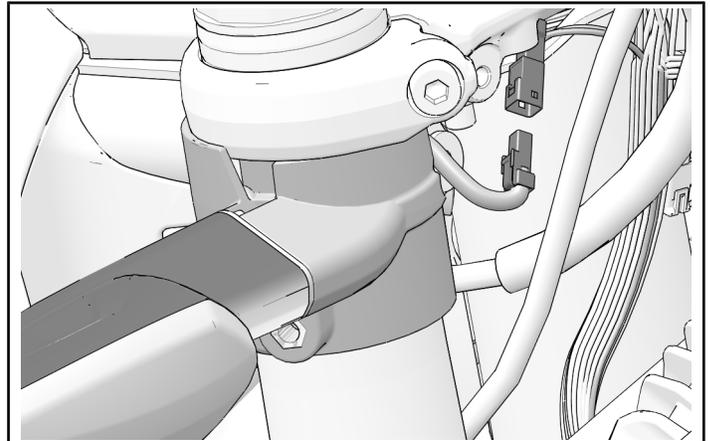
2. Extraiga y guarde un tornillo (A) y una arandela (B) del soporte del intermitente. Desmonte el conjunto del intermitente de la motocicleta.
