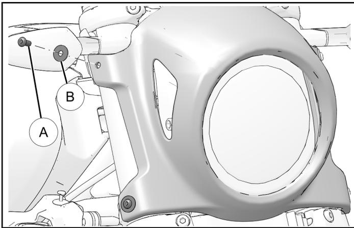
2. Quite la cubierta del faro delantero y póngala a un lado para la reinstalación.
