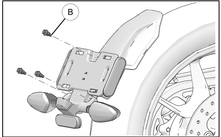
4. Acople los conectores del intermitente del lado derecho, del intermitente del lado izquierdo y de la matrícula con los conectores correspondientes en el arnés del chasis.
