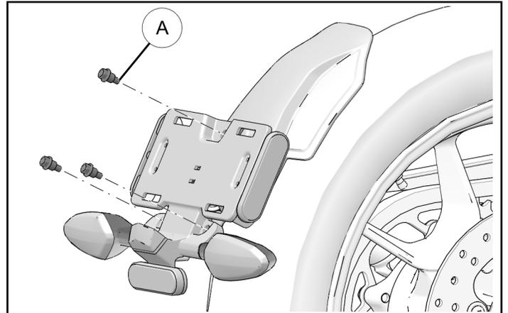
4. Apriete las dos lengüetas del soporte de la matrícula para desmontarla del protector contra residuos. Durante el desmontaje, será necesario sacar los arneses de la abertura del protector contra residuos.
