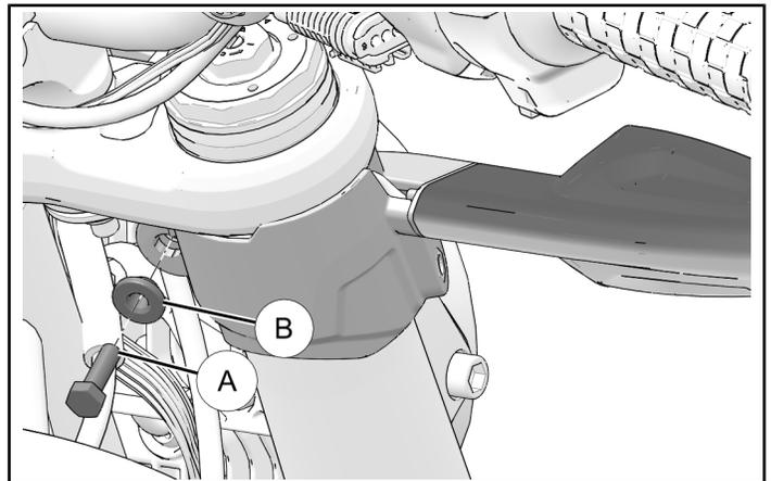
3. Extraiga y guarde un tornillo © del interior del soporte del intermitente para desinstalar el intermitente de serie. Deseche el intermitente de serie.
