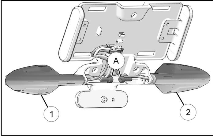
2. Pase los arneses de los intermitentes y de la matrícula a través de la abertura del protector contra residuos antes de volver a colocar el soporte de la matrícula en el protector contra residuos. Asegúrese de que los dos soportes de la matrícula encajen perfectamente en el protector contra residuos.
