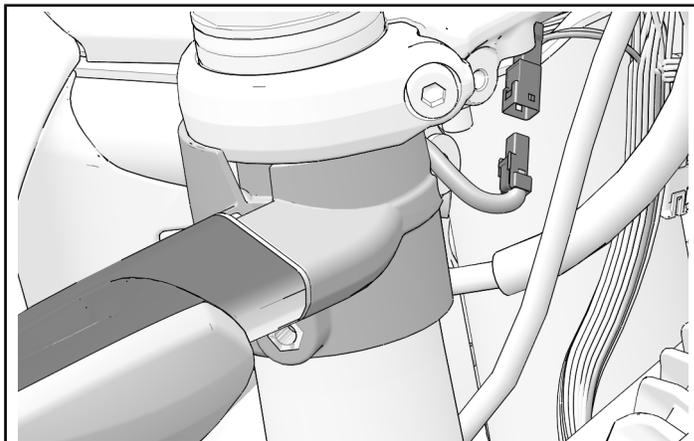
2. Retirer et conserver une vis **A** et une rondelle **B** du support des clignotants. Retirer les clignotants de la motocyclette.
