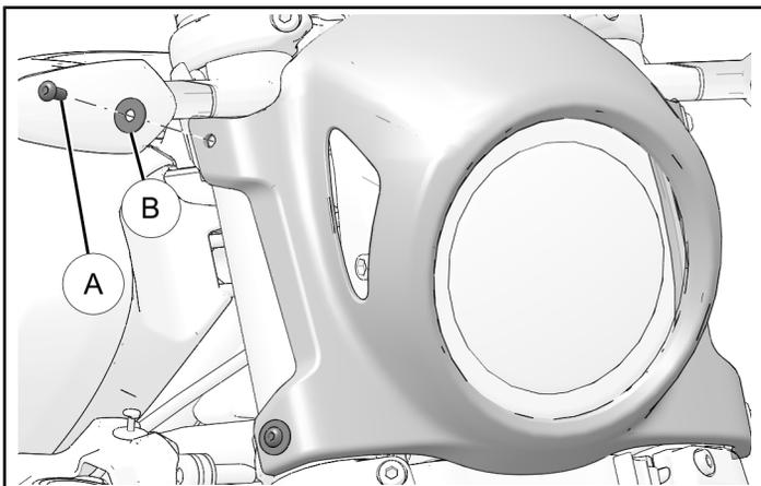
2. Retirer le capot du phare et le mettre de côté pour le remontage.
