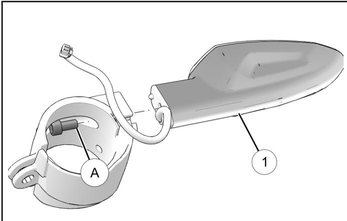
2. S'assurer que le faisceau de clignotants ① se trouve à l'intérieur du canal de montage des clignotants.
