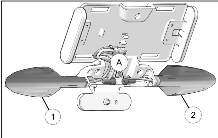
2. Faire passer les faisceaux de clignotants et de plaques d'immatriculation par l'ouverture du garde-boue avant de remplacer le support de plaque d'immatriculation sur le garde-boue. S'assurer que les deux supports de plaque d'immatriculation sont parfaitement fixés sur le garde-boue.
