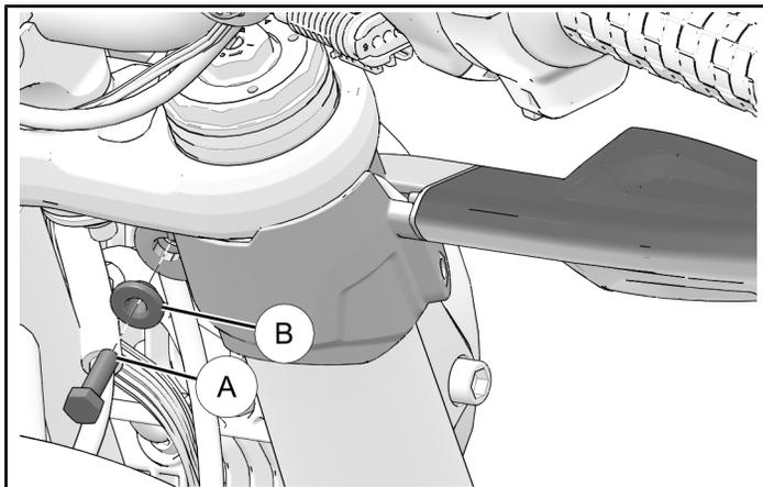
3. Retirer et conserver la vis ③ de l'intérieur du support de clignotant pour démonter le clignotant de série. Jeter le clignotant de série.
