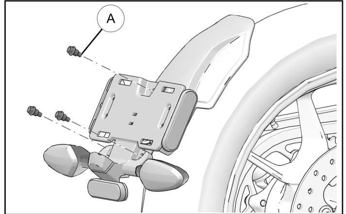
4. Pincer deux languettes sur le support de plaque d'immatriculation pour le démonter du garde-boue. Les faisceaux devront être retirés de l'ouverture du garde-boue lors du démontage.
