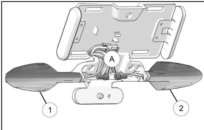
2. 布设转向信号线束和车牌线束时，先将线束穿过防护挡板上的开口，再将车牌支架装回到防护挡板上。确保两个车牌支架都完全卡入防护挡板。
