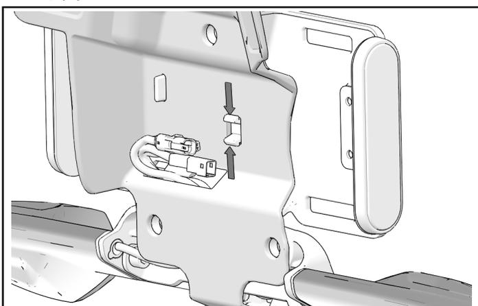
5. 从两侧的转向信号处各卸载下两枚螺钉并妥善保管。
