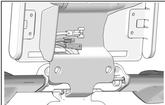
3. 使用三枚螺钉①将车牌组件装回到车牌臂上。
