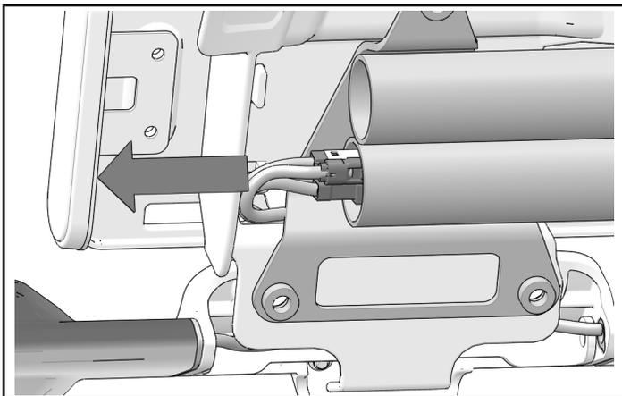
3. 卸下三枚螺钉①并妥善保管，将车牌组件从车牌臂上拆下。将车牌支架置于干净的表面上。
