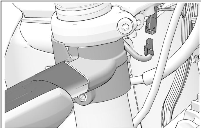
2. 将转向信号支架上的一枚螺钉①和一个垫圈②卸下并妥善保管。将转向信号组件从摩托车上拆下。
