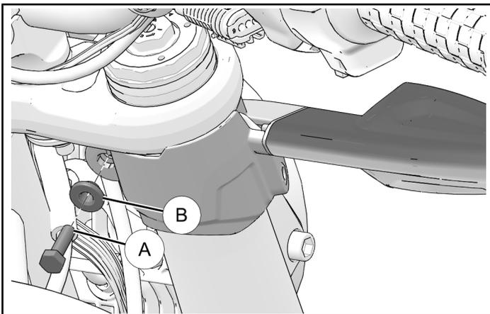
3. 将转向信号支架内的一枚螺钉③卸下并妥善保管，接着拆下原有的转向信号。弃置原有的转向信号。
