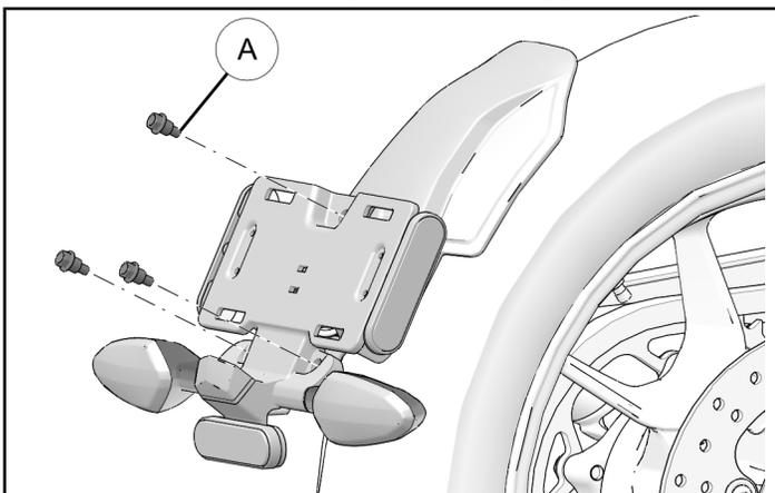
4. 按下车牌支架上的两个卡扣，将防护挡板从车牌支架上拆下。拆解过程中需从防护挡板开口处拉出线束。
