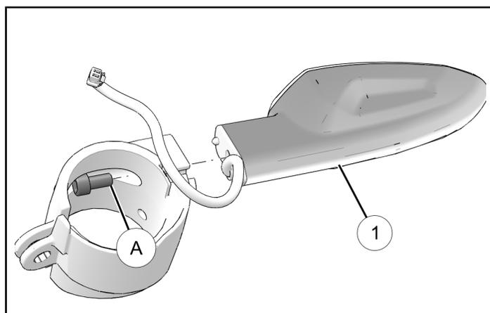
2. 请确保将转向信号①的线束布设在转向信号支架的通道内。
