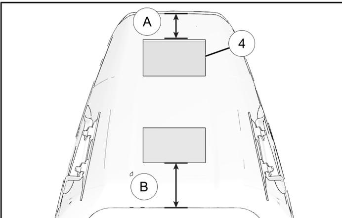
4. Sitzverkleidungsgruppe über den hinteren Teil des Sitzes positionieren und die vorher verwendeten Befestigungsteile ① durch die Soziushaltegriffe und die Sitzverkleidungshalterungen führen.
