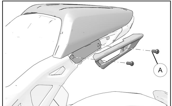
5. Ajuste la altura de la cubierta del asiento para asegurarse de que sea uniforme la separación a lo largo del bastidor auxiliar y la luz trasera.
