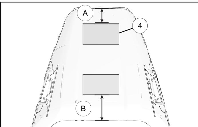
4. Collocare il gruppo del codino della sella sulla parte posteriore della sella e far passare i dispositivi di fissaggio ④A messi da parte precedentemente attraverso le maniglie del passeggero e le staffe del codino della sella.
