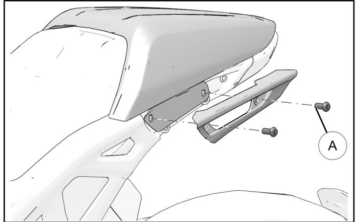
5. Regolare l'altezza del codino della sella per garantire che vi sia uno spazio uguale lungo il sottotelaio e la luce posteriore.
