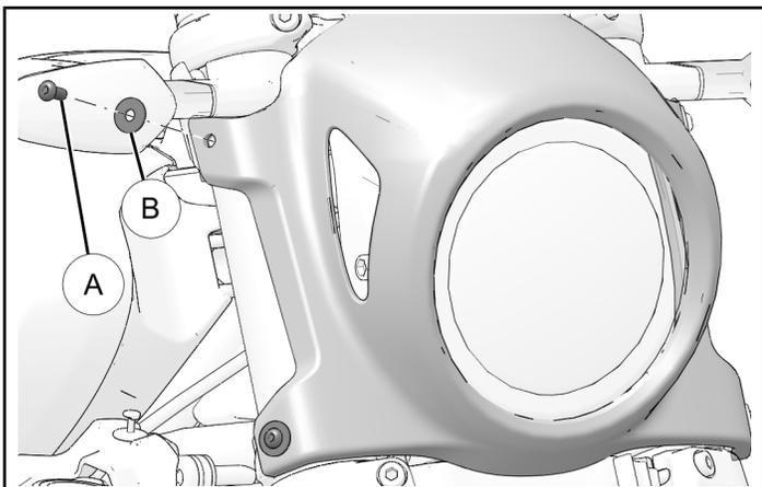
2. Retirer le capot de phare et le mettre de côté pour le remontage.
