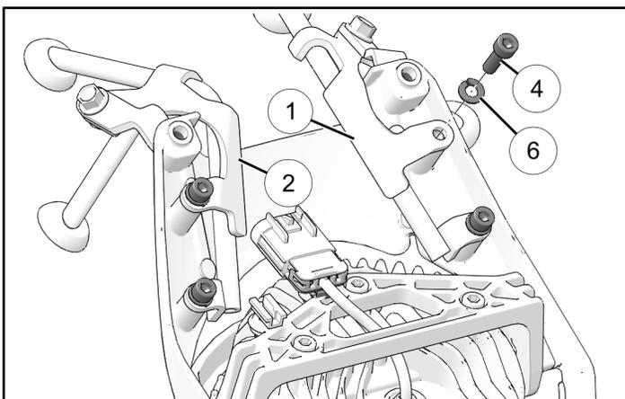
5. Raccorder le connecteur du phare au connecteur du faisceau de cadre. Remonter la connexion de l'ETC sur l'attache à goupille d'arrêt, à l'arrière du support de phare.
