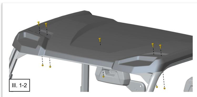
4. Posez sans les serrer quatre vis Torx M6 x 25 mm (2) et quatre bagues en nylon (3) dans les trous de montage arrière. Les bagues en nylon se placent entre le toit en polyéthylène et la cage de retournement. Les vis Torx traceront des filets dans les trous d'origine pratiqués dans la cage de retournement. (Voir l'illustration 1-3.)
