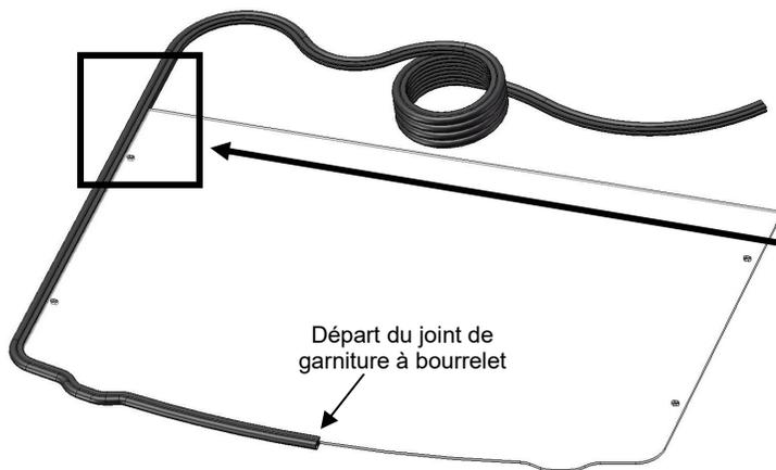
Aligné avec la partie supérieure du pare-brise, effectuez 2 coupes à 45 deg. tel qu'indiqué ci-dessous (pour éviter toute infiltration d'eau, assurez-vous de ne pas couper la section spongieuse du joint).
