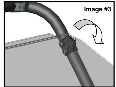
3. Tirer légèrement le pare-brise vers l'avant du véhicule tel que montré à l'image #2 pour obtenir la position maximale des pivots supérieurs sur les cylindres de pivot.
