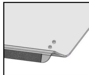
c) Attachez les brides (Article E & F) à la cage protectrice tel que montré. Les brides inférieures doivent être installées de façon à ce que les inserts filetés pointent vers l'avant du véhicule. Les brides supérieures doivent être installées de façon à ce que les inserts filetés s'alignent de droite à gauche de la cage protectrice. **Ne pas serrer à cette étape, vous devrez faire des ajustements plus tard.**
