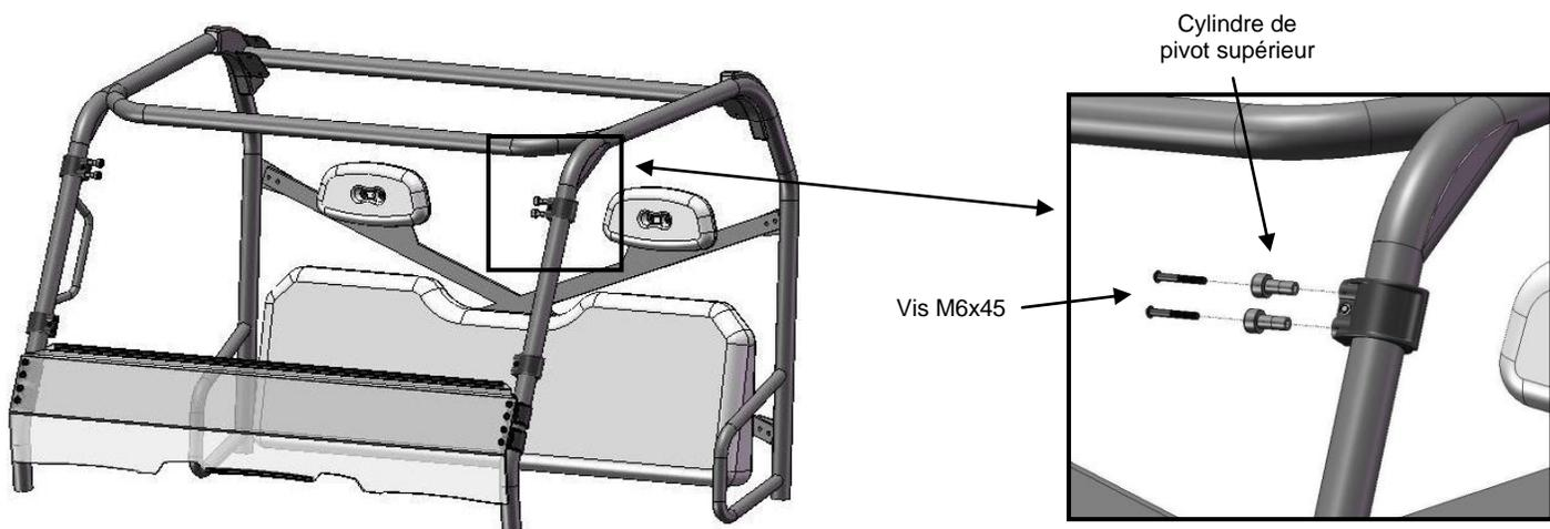
g) Fixez le pare-brise au véhicule en suivant les instructions suivantes.
