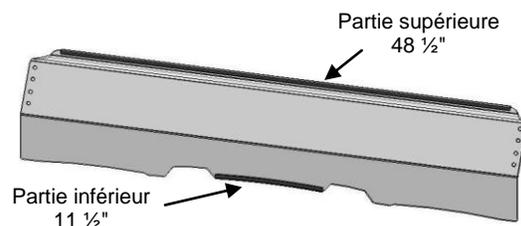
b) Trouvez un endroit propre ou vous pouvez déposer le pare-brise sans risquer de l'endommager. Afin d'installer la bande absorbante (Article D) au pare-brise supérieur (Article A), retirer partiellement le papier protecteur nécessaire. Appliquer ensuite la bande absorbante autoadhésive en exerçant une pression ferme sur toute la longueur pour vous assurez d'une bonne adhésion.
