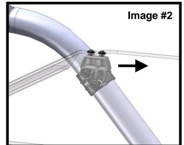
3. Tirez légèrement le pare-brise vers l'avant du véhicule tel que montré à l'image #2 pour obtenir la position maximale des pivots supérieurs sur les cylindres de pivot.
