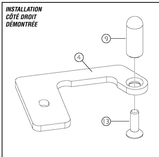
7. Retirer la vis mécanique d'origine retenant le repose-pied au châssis tel qu'illustré.
